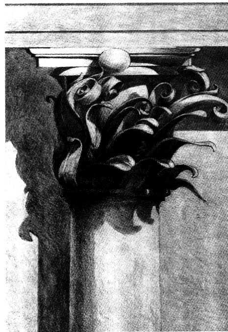
Fig. 40. Il capitello dell'ordine composto delineato da G. Barozzi da Vignola nella tav. XXVII della Regola delle cinque ordini d'architettura , Roma 1562, in AA.VV., P. Cataneo, G. Barozzi da Vignola, Trattati... , Milano 1985.
